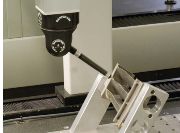
PH20正在检测EMA的多叶片零件AEREO
