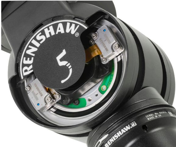
安装在REVO-2测座中的ATOM光栅： 两个读数头用于校正码盘偏心。
