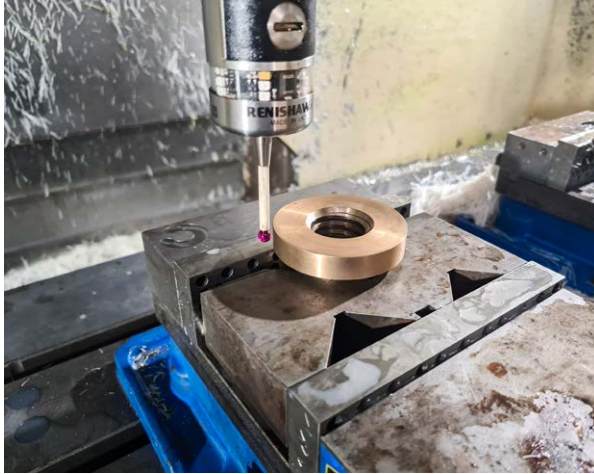
使用雷尼绍OMP40-2光学测头执行工件找正和检测
