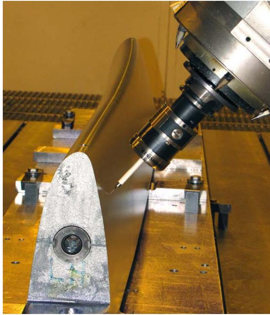
*Die patentierte RENGAGE Technologie erlaubt das Messen aus jeder Richtung nach einmaliger Kalibrierung. Zu beachten ist das Bauteilprofil. Die Messroutine wird offline in der Software OMV Pro programmiert und auf einer CNC-Steuerung 840D von Siemens ausgeführt; die Ergebnisauswertung erfolgt wiederum offline auf einem PC.*
