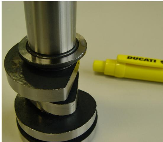
*Die Desmodromik-Nockenwelle ist keine herkömmliche Nockenwelle und wurde mit speziellen „Heberampen“ konstruiert*
