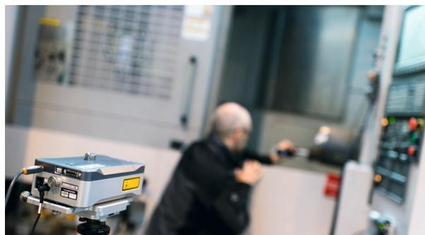
Craig Simpson, Wartungstechniker bei FMC Technologies, überprüft mit dem XL-80 Laserkalibriersystem die Maschinengenauigkeit.
