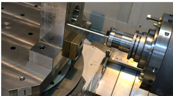
Ein RMP60 Messtaster beim Einsatz auf einer Werkzeugmaschine bei FMC Technologies
