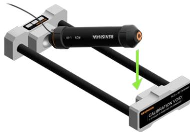
2. Fahren Sie das Gerät so weit aus, dass das gegenüberliegende Ende des Messstabs die gegenüberliegende Kugelfläche der Kalibriervorrichtung erreicht. Vergewissern Sie sich, dass der RCS L-90 Messstab magnetisch an der Kalibriervorrichtung andockt.
