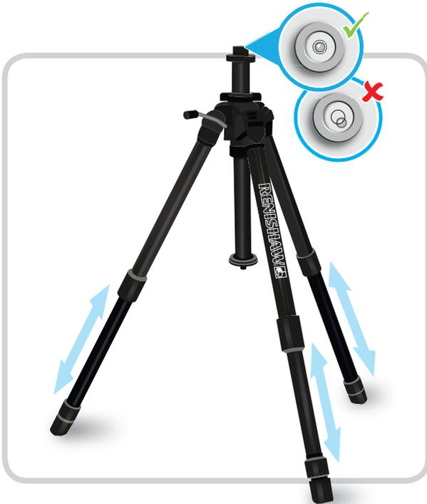
**HINWEIS:** Ein Stativ sollte dann verwendet werden, wenn eine korrekte Befestigung der Stahleinheit an der Maschinenstruktur nicht möglich ist. Die Strahleinheit ist die Referenz. Jede Instabilität des Stativs wird daher die Genauigkeit der Messungen beeinflussen.
