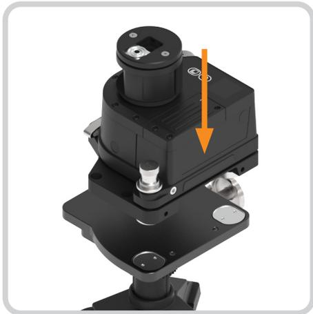
Richten Sie die Magnetfüße an den Polstern aus. Setzen Sie die Strahleinheit auf den Stativ-Verschiebetisch.
