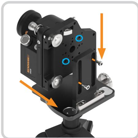
Befestigen Sie die Strahleinheit mit den Schrauben am Tisch, und zwar an der 90-Grad-Halterung.
