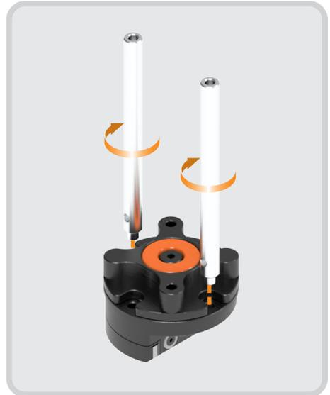
Schrauben Sie die Säulen in den Magnetfuß mit drehbarem Kopf. Schieben Sie die M-Einheit auf die Säulen und befestigen Sie sie mit den Rändelschrauben.
