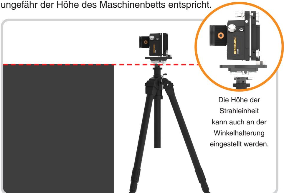
**Positionieren Sie die M-Einheit oder die Pentaprisma-Optik optisch „parallel“ zur Strahleinheit.**
