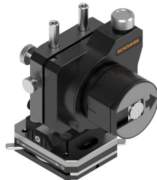
**HINWEIS:** Der Magnetfuß mit minimaler Bauhöhe kann in beiden Ausrichtungen verwendet werden. Berücksichtigen Sie beim Aufbau den erforderlichen Zugang zum Pentaprisma-Verschiebetisch.
