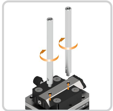
Schrauben Sie die Säulen in den Pentaprisma-Verschiebetisch. Schieben Sie dann die Pentaprisma-Optik auf die Säulen und befestigen Sie sie mit den Rändelschrauben.
