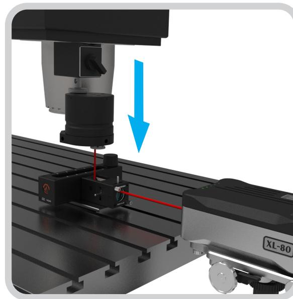
Senken Sie die Spindel zur Baugruppe auf der Grundplatte für Geradheitsmessungen ab. Achten Sie dabei darauf, dass:
