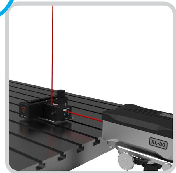
Entfernen Sie die Zielmarke von der LS350 Strahlsteueroptik.
