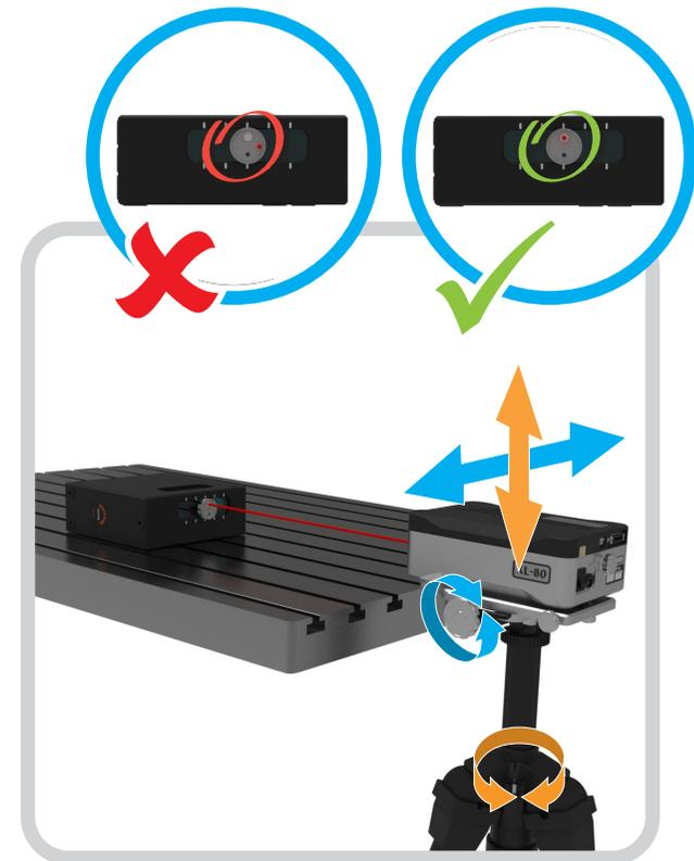
Stellen Sie den Strahl mithilfe der Stellschrauben auf die Mitte des weißen Zielpunktes ein.
