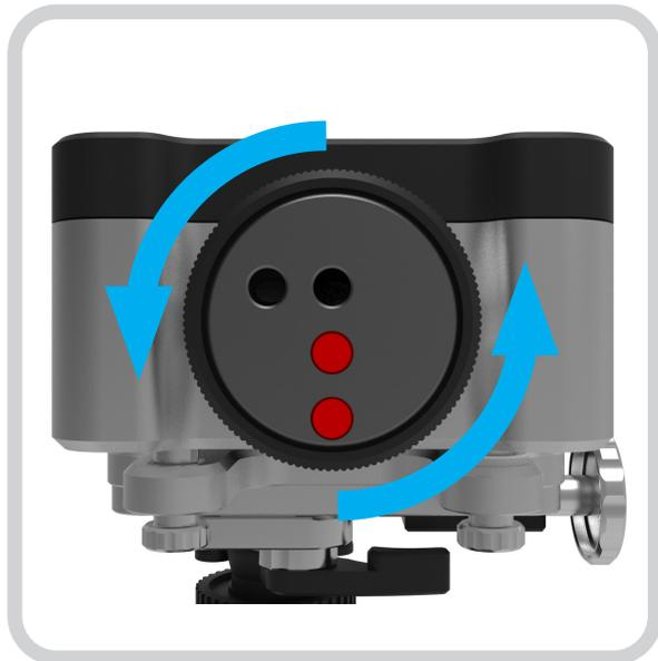
Drehen Sie den schwarzen Ring an der Ausgangsoptik zur Geradheitsmessung, bis die großen Öffnungen offen sind.
