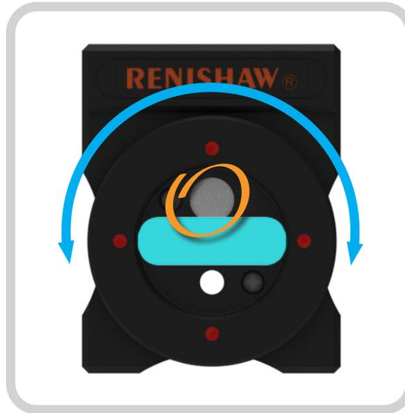
Drehen Sie das Geradheitsinterferometer, bis sich der weiße Zielpunkt oben befindet.
