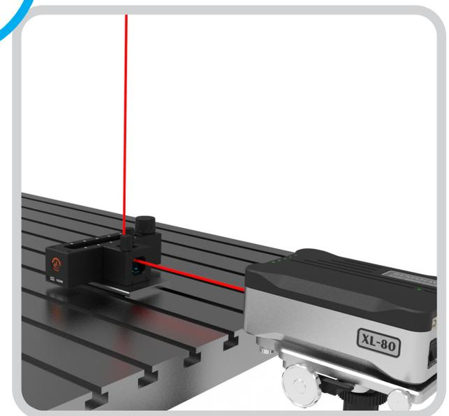
Entfernen Sie die Zielmarke vom vertikalen Umlenkspiegel.
