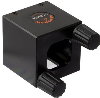
Der vertikale Umlenkspiegel wird für Geradheitsmessungen entlang vertikaler Achsen verwendet, kann aber auch für manche Messungen an horizontalen Achsen genutzt werden. Der Spiegel lenkt den linearen Strahl um nominell 90 Grad ab.
