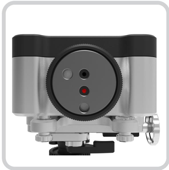
Drehen Sie den schwarzen Ring an der Ausgangsoptik der Lasereinheit, bis der Strahl mit verringertem Durchmesser emittiert wird.
