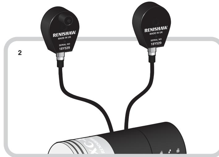
Schließen Sie den Luft- und den Materialsensor an der XC Umweltkompensationseinheit an.
