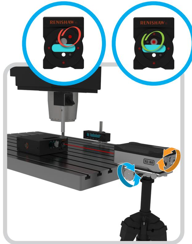
Korrigieren Sie den Nick- und Gierwinkel an der Lasereinheit und richten Sie den Strahl auf die Mitte des weißen Zielpunktes aus.
