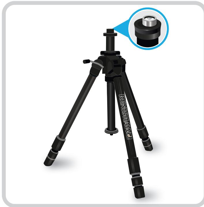
Setzen Sie die Libelle auf den Stativanschluss.
