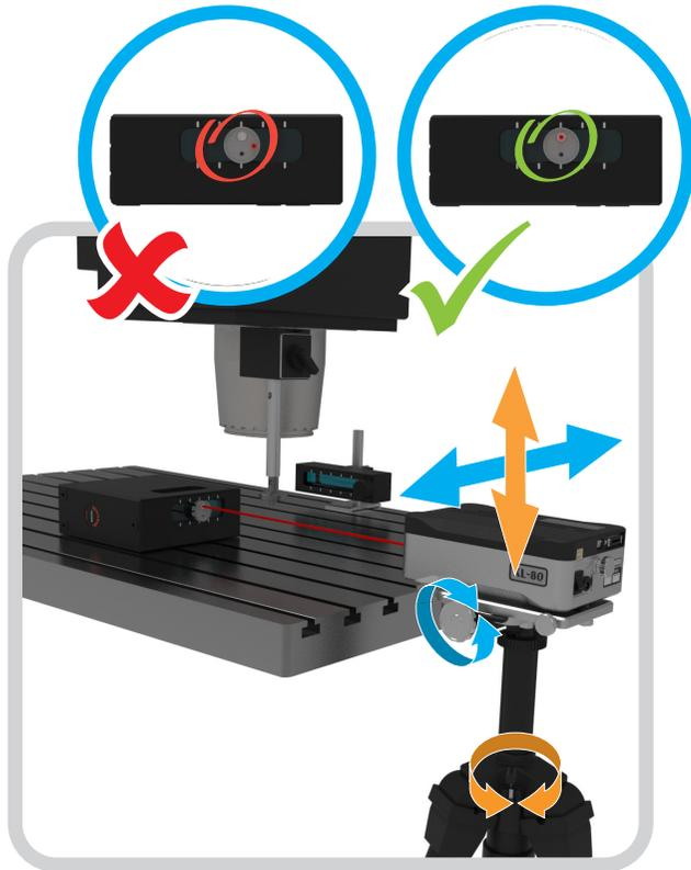
Verstellen Sie die Lasereinheit, bis der Strahl auf die Mitte des am Pentaprisma angebrachten weißen Zielpunktes trifft.
