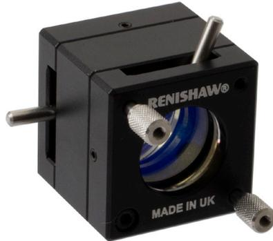
Die Lasersteueroptik ist eine Ausrichthilfe für das XL Lasersystem. Das Gerät ermöglicht die einfache Einstellung des Laserstrahls in vertikaler und horizontaler Ebene und reduziert die am Laserkopf über die Stativplatte vorzunehmenden Einstellungen.
