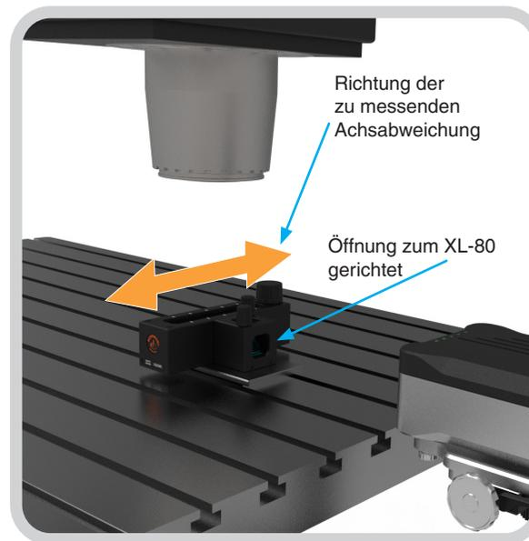
Positionieren Sie die Baugruppe auf der Grundplatte für Geradheitsmessungen so, dass:
