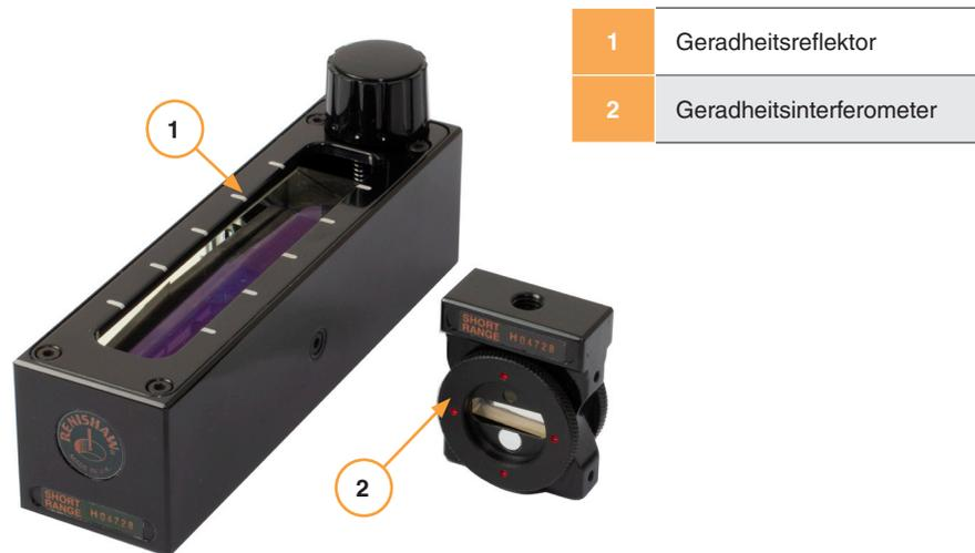
**HINWEIS:** Das folgende Zubehör wird benötigt, wenn die vertikale Geradheit in einer horizontalen Achse – beziehungsweise die Geradheit in einer vertikalen Achse einer Maschine – gemessen werden soll:
