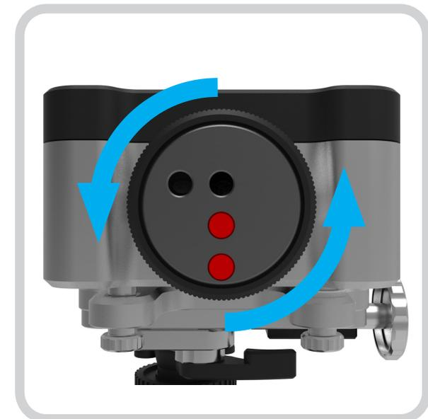
Drehen Sie den schwarzen Ring an der Ausgangsoptik zur Geradheitsmessung, bis die großen Öffnungen offen sind und der 6-mm-Strahl emittiert wird.
