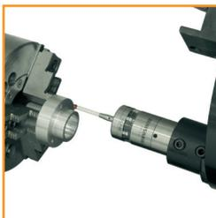
**Werkstückmesstaster** für automatisierte Messungen der Position und Ausrichtung von Bauteilen.
