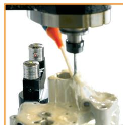
**Werkzeugkontrollsysteme** ermöglichen die dynamische Einrichtung von Schneidwerkzeugen in der Werkzeugmaschine.
