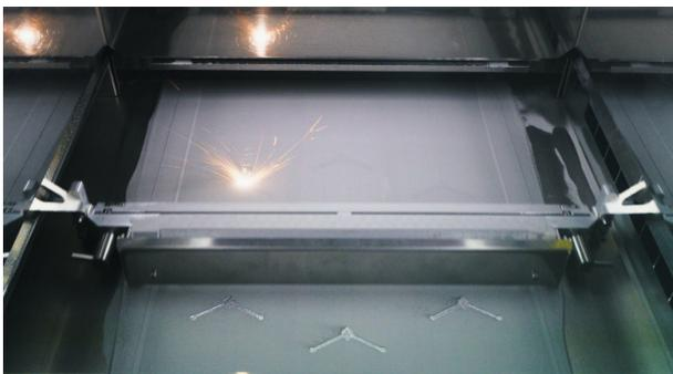
Bei herkömmlichen Laserschmelzsystemen muss der Pulverbeschichter das Pulver vollständig verteilt haben, bevor die Fertigungsschicht bearbeitet werden kann. Mittels TEMPUS-Technologie können die Laser das Pulverbett bearbeiten, während der Beschichter verfahren wird.
