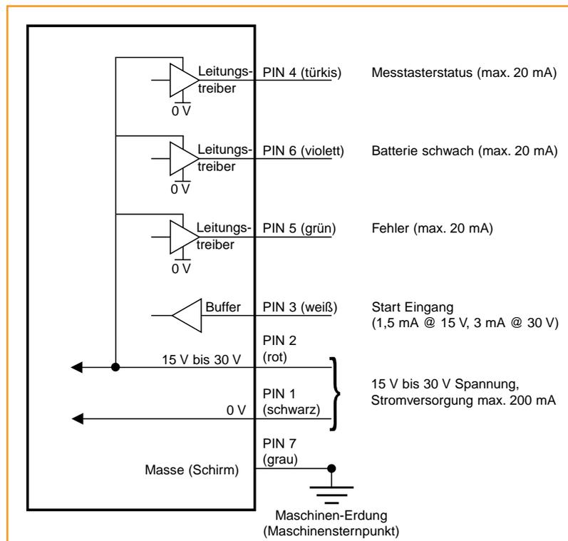
**⚠ VORSICHT:** Die 0 V Spannungsversorgung muss an die Maschinen-Erdung (Maschinensternpunkt) angeschlossen werden.
