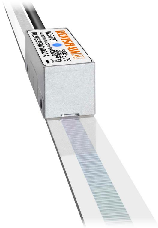
**Der absolute ZeroMet™ RELA30 Maßstab wird aus einer Legierung mit geringer thermischer Ausdehnung hergestellt, die hochgenaue Messungen über den gesamten Betriebstemperaturbereich gewährleistet.**
