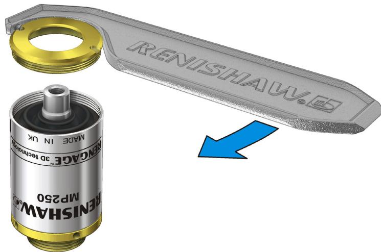
7. Zentrierwerkzeug entfernen. Taster befestigen und den Messtaster neu kalibrieren (für nähere Informationen siehe **Seite 3-2** „Montage des Tasters“ und **Seite 3-6** „Kalibrierung des MP250“).
