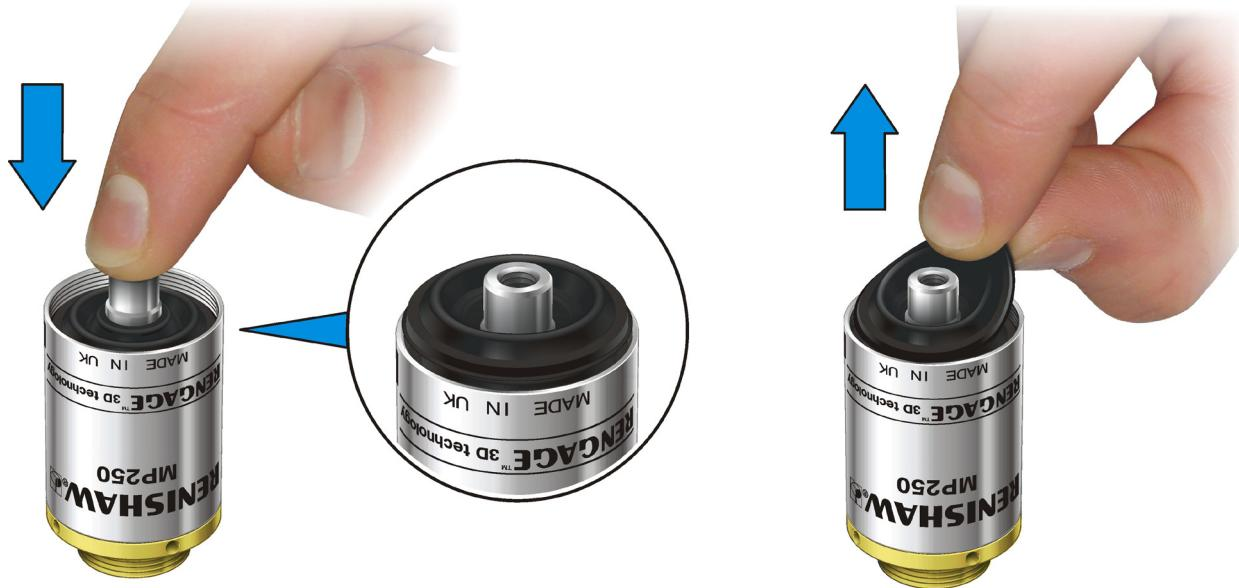
2. Das mit dem Dichtungs-Ersatzteilkit mitgelieferte Zentrierwerkzeug für Dichtungen (Renishaw Art. Nr. A-5500-1652) in den Tasterhalter einschrauben.
