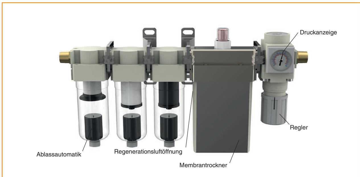
Befestigen Sie die Luftaufbereitungsanlage mit den Montagehalterungen senkrecht an einer geeigneten Fläche. Die Position darf max. 25 m von der NC4+ Blue-Einheit entfernt sein.
