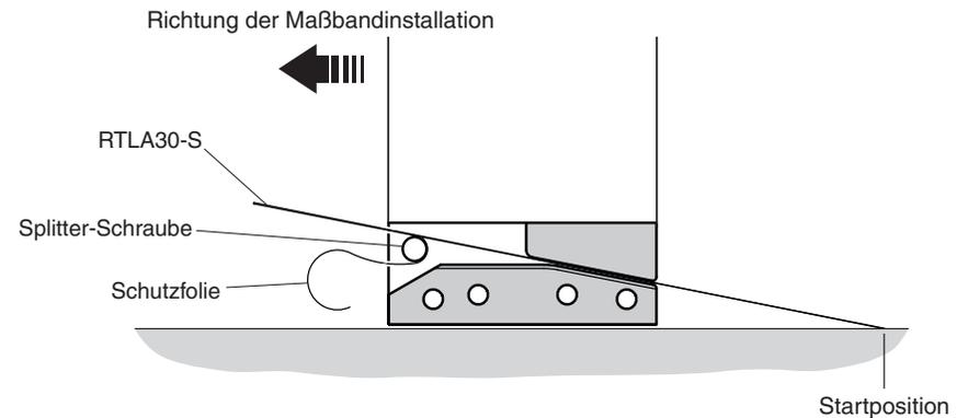
9. Drücken Sie das Maßband während der Installation durch leichten Fingerdruck fest, um sicherzustellen, dass es gut auf dem Untergrund haftet.
