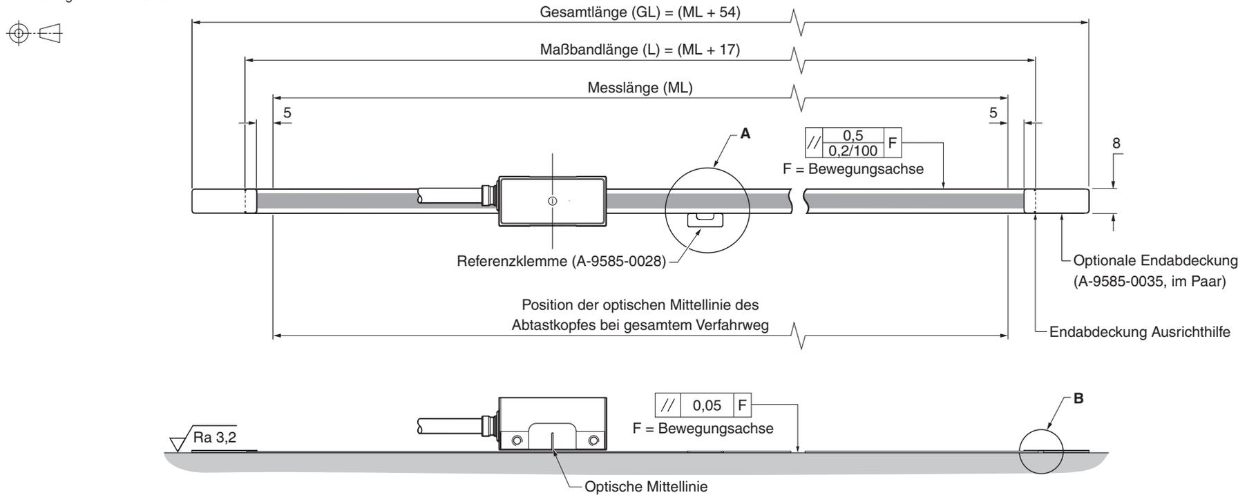
**Die Ausrichtung des Maßbands ist maßgeblich für die Zählrichtung**
