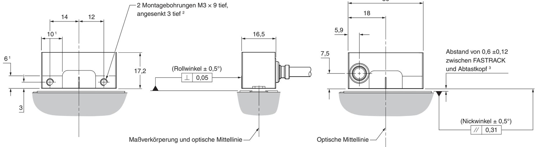
**HINWEIS:** RESOLUTE Abtastkopf abgebildet mit RTLA30/FASTRACK Maßbandsystem.
