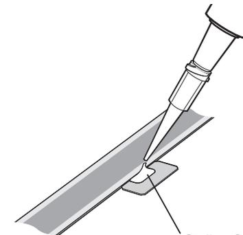
Stellen Sie sicher, dass der Kleber über die gesamte Länge der Öffnung verteilt ist.
