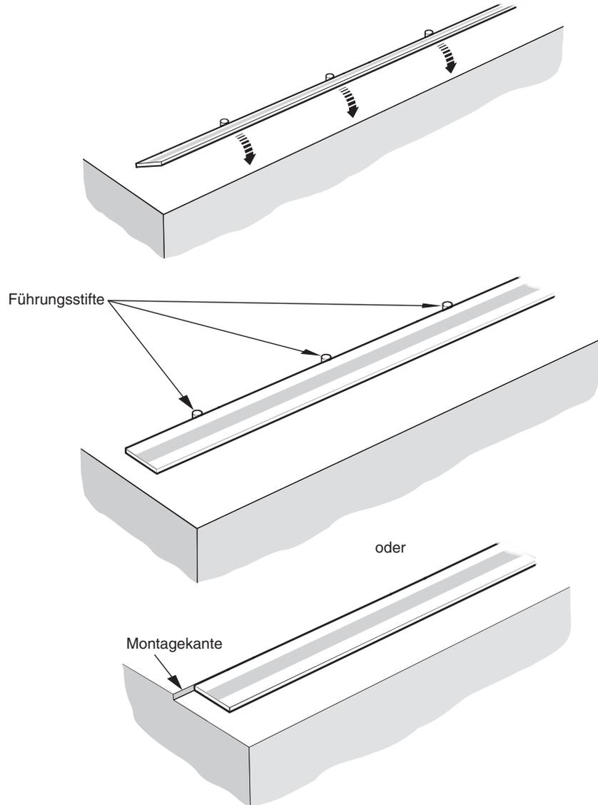
6. Überschüssigen Epoxidkleber entfernen.
