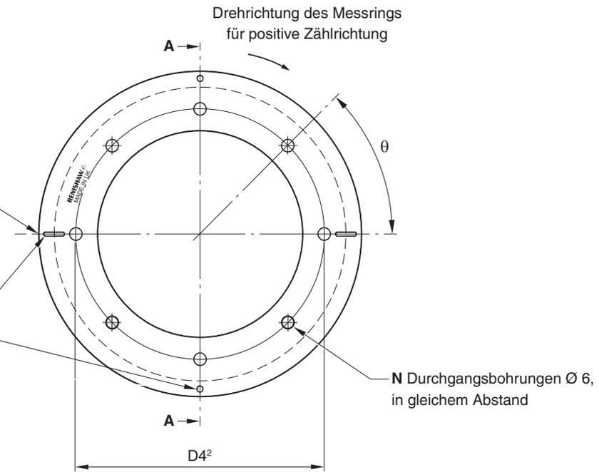
N Durchgangsbohrungen Ø 6, in gleichem Abstand
