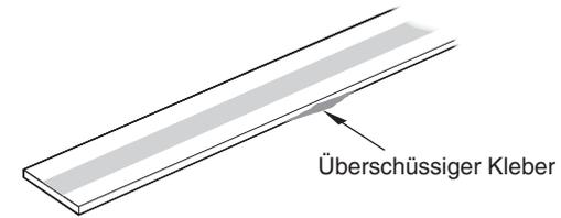
7. Warten Sie 24 Stunden, bis der Epoxidkleber vollständig getrocknet ist, reinigen Sie den Maßstab dann mit den Reinigungstüchern von Renishaw oder einem sauberen, trockenen, faserfreien Tuch.
