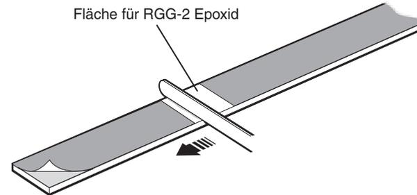
5. Legen Sie den Maßstab an die Stifte oder die Anschlagkante an und drehen Sie ihn auf die Installationsfläche. Anschließend den Maßstab noch einmal fest andrücken.
