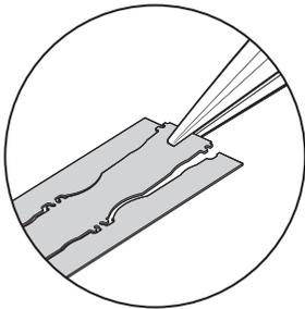
4. Entfernen Sie die Schutzfolie an der Rückseite des FASTRACK und kleben Sie dieses entlang der Nut/Führungskante oder der Stifte auf den Untergrund.
