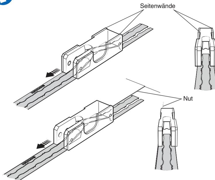
6. Führen Sie das RTLA30 Maßband in das FASTRACK ein. Vergewissern Sie sich, dass das Maßband wie unten dargestellt unter den Auskragungen verlegt wird.
