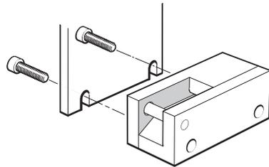
**HINWEIS:** Die Montagehilfe für das Maßband kann nach beiden Seiten ausgerichtet werden, um die Installation zu vereinfachen.
