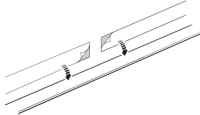
2. Die Fläche für den Epoxidkleber auf dem Klebeband markieren und es entsprechend abschneiden. Die Referenzklemme fixiert die Maßverkörperung an der gewünschten Stelle fest auf dem Untergrund.
