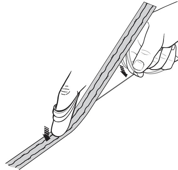
Drücken Sie das FASTRACK an, indem Sie mit dem Finger fest von der Mitte in beide Richtungen streichen. Verwenden Sie hierbei gegebenenfalls ein faserfreies Tuch.
