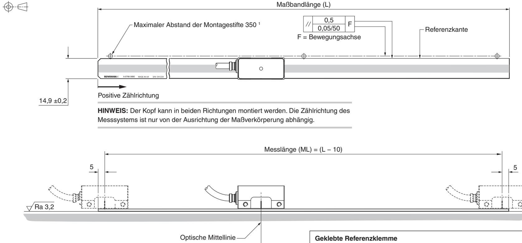
**HINWEIS:** Der Kopf kann in beiden Richtungen montiert werden. Die Zählrichtung des Messsystems ist nur von der Ausrichtung der Maßverkörperung abhängig.
