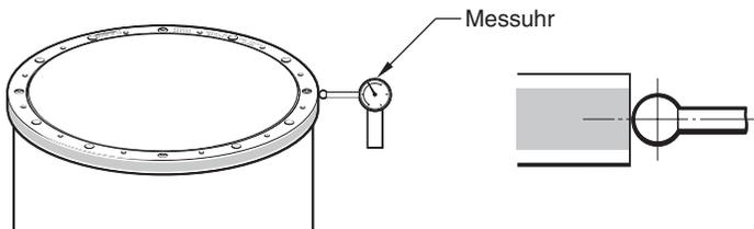
Eine Messuhr mit niedriger Antastkraft verwenden, um sicherzustellen, dass die Oberfläche der Maßverkörperung nicht verkratzt wird. Als zusätzliche Vorsichtsmaßnahme werden außerdem Messuhren mit Rubinkugel empfohlen.
