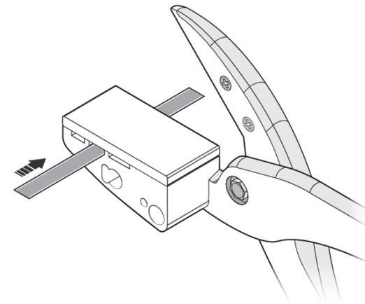
Halten Sie das Maßband fest in seiner Position und schließen Sie die Schere zum Schneiden des Maßbands gleichzeitig in einer fließenden Bewegung nach unten.
