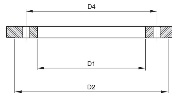
Die Abmessungen D1, D2, D3, D4 und die Anzahl der Bohrungen N finden Sie im Abschnitt [„Abmessungen REXA30 Ring“](#) auf Seite 39.
