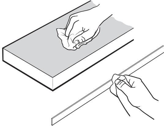
3. Die Schutzfolie des doppelseitigen Klebbands auf einer Seite entfernen und auf die Unterseite des Maßstabs kleben.
