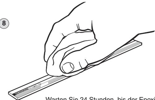
Warten Sie 24 Stunden, bis der Epoxidkleber vollständig getrocknet ist, reinigen Sie den Maßstab dann mit den Reinigungstüchern (A-9523-4040) von Renishaw oder einem sauberen, trockenen, faserfreien Tuch.
