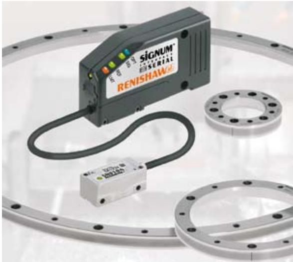
Si-FN Interfaces sind mit drei verschiedenen Auflösungsoptionen erhältlich: 'Normal' bietet 20-Bit Auflösung (0,003°) und bis zu 4.500 min<sup>-1</sup>, 'High Type A' bietet 23-Bit (0,00043°) und 'High Type B' 26-Bit (0,0000054°) Auflösung für höchste Präzision bei bis zu 600 min<sup>-1</sup>.
