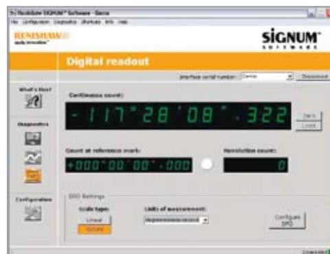
Alle **SiGNUM**™ Mess-Systeme von Renishaw können über den USB-Port mit einem PC verbunden werden. Durch die umfangreiche **SiGNUM**™ Software kann eine optimale Justage sowie eine Echtzeitdiagnose auch im Regelbetrieb durchgeführt werden. Das Si-FN ermöglicht zudem eine digitale Ausgabe für weitergehende Diagnose.
