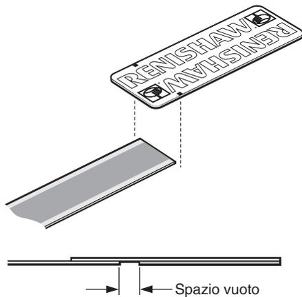
**NOTA:** si noterà uno spazio fra l'estremità della riga e il nastro adesivo della copertura di estremità.
