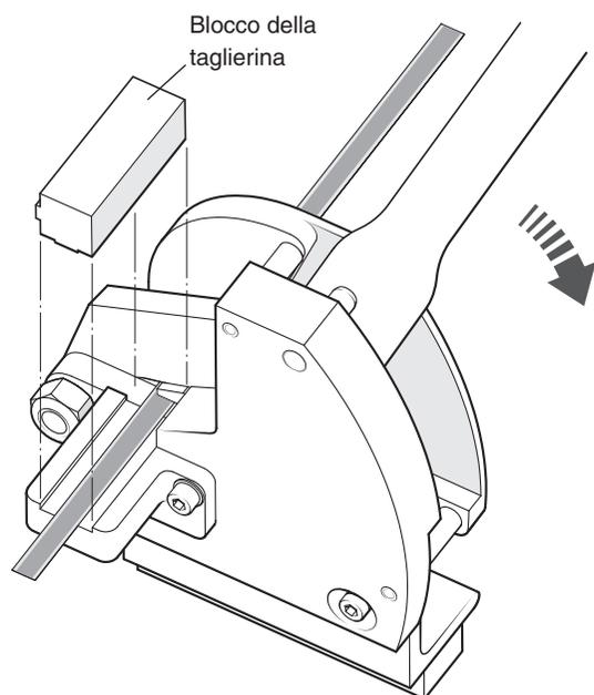
Tenere il blocco in posizione e abbassare la leva con un movimento fluido, per tagliare la riga fino in fondo.
