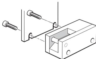
**NOTA:** l'applicatore può essere montato in entrambe le posizioni, per semplificare al massimo l'orientamento e l'installazione della riga.
