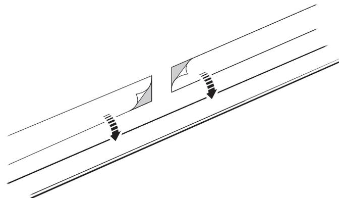
2. Contrassegnare l'area di applicazione dell'adesivo epossidico sul nastro e tagliare il nastro. Il morsetto di riferimento fissa saldamente la riga al substrato, sul punto selezionato.
