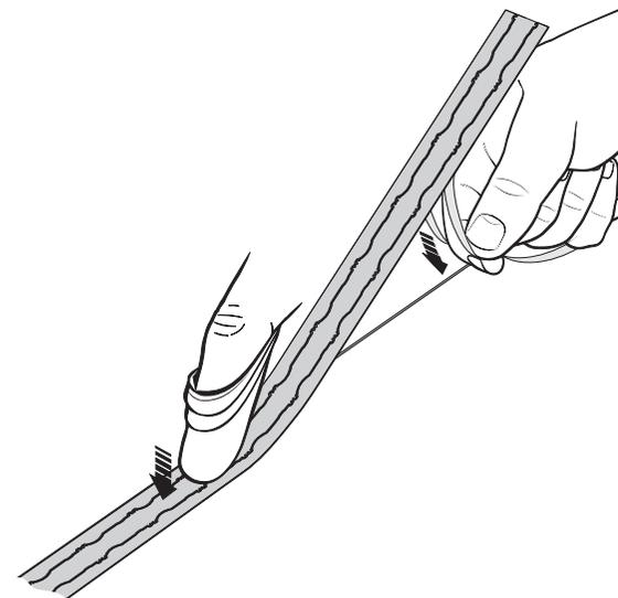
Assicurare la completa adesione al substrato applicando una decisa pressione con il dito lungo tutta la guida *FASTRACK* dal centro verso l'esterno e verso ciascuna estremità utilizzando, se necessario, un panno pulito.
