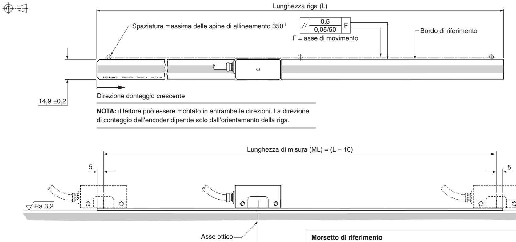
**NOTA:** il lettore può essere montato in entrambe le direzioni. La direzione di conteggio dell'encoder dipende solo dall'orientamento della riga.
