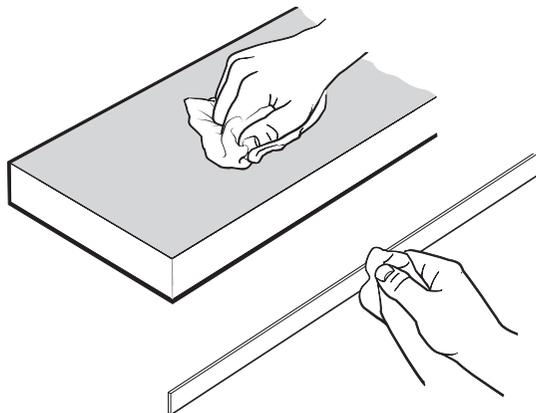
3. Rimuovere la striscia protettiva da un lato del nastro adesivo e fissarlo sul retro della riga.
