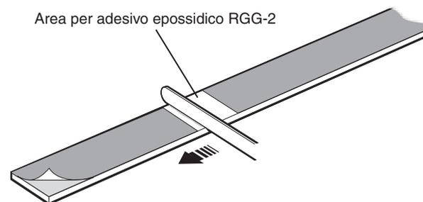
5. Posizionare la riga contro le spine o una battuta e ruotarla sul substrato. Premere a fondo con le dita.
