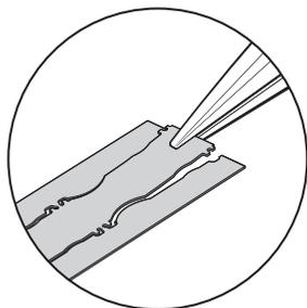
4. Rimuovere la striscia protettiva e incollare *FASTRACK* al substrato, posizionandola contro la battuta, i bordi in rilievo o le spine.
