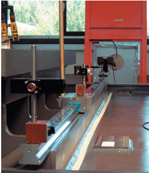
Bild 2. Auf's \mu\text{m} genau: Seitliche Abweichungen der Führungsschiene von der idealen Geradheit erkennt das Lasermessgerät durch Fahren der Optik über die gesamte Schienenlänge
