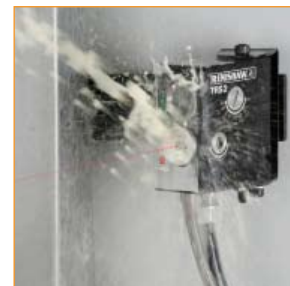
TRS2 – sistem de detecție a ruperii sculei
