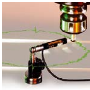
QC10 Ballbar – testare rapidă a performanțelor mașinilor unelte
