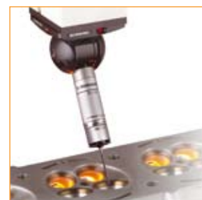
SP25M traductor de scanare – permite înregistrarea rapidă și continuă a datelor
