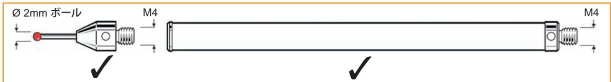
小径部分が短いスタイラス軸が使用され、各パーツを接合するM4ネジ部の剛性が高くなります。
