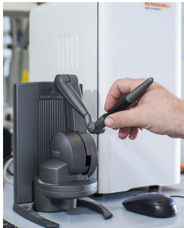
Dispositivo Haptic y escáner dental DS20
