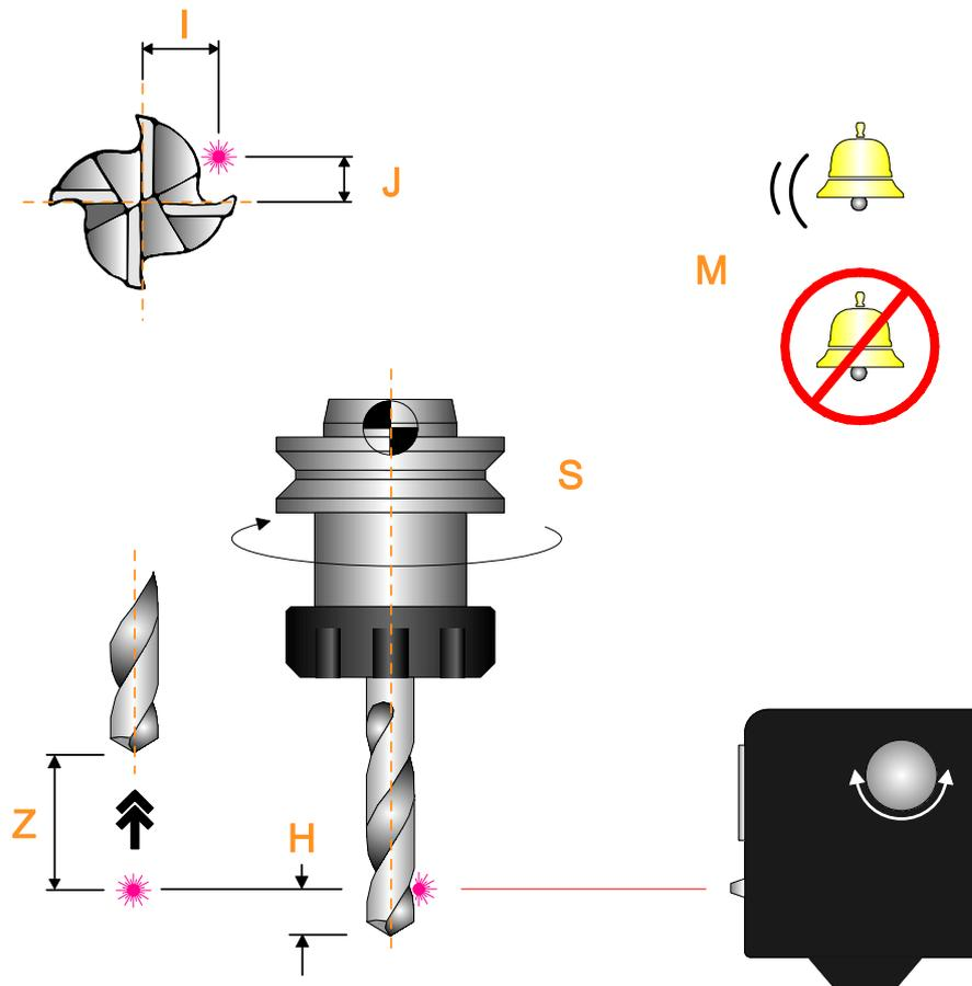
Typischerweise muss ein Werkzeug nach einem Bearbeitungsvorgang auf Werkzeugbruch geprüft werden, bevor das nachfolgende Werkzeug zum Einsatz kommt.
