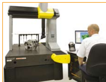
Software MODUS™ můžeme dodat jako součást kompletního řešení modernizace pro jakoukoli značku souřadnicového měřicího stroje.
