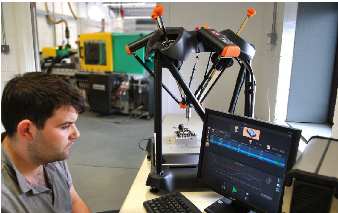
David Powell正在使用Equator比对仪测量工件
