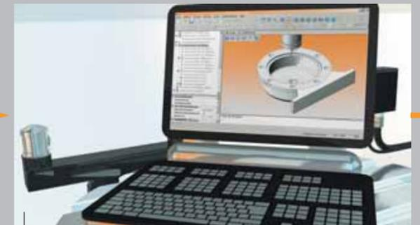
**5** Die Vorbearbeitung der zirkulargefrästen Passung erfolgt mit Schlichtaufmaß. Mit dem OMP60 wird die Maßabweichung erfasst und als Radiusverschleiß in die Werkzeugtabelle geschrieben. Nach der Aktivierung der korrigierten Werkzeugdaten kann die Schlichtbearbeitung fertiggestellt werden.
