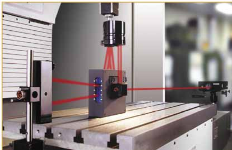
在 VMC 機器上做 X-Z 軸垂直度量測
