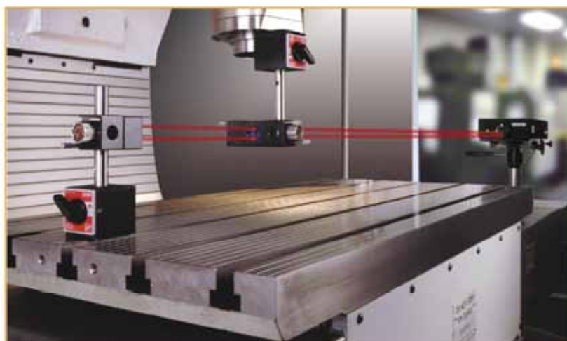
VMC 機器上進行 X 軸量測
