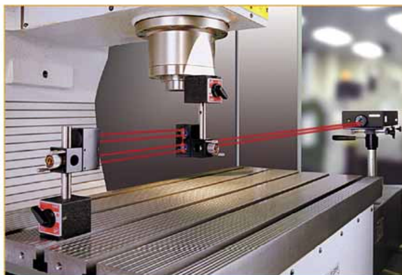
在移動式工作臺的 VMC 機器上進行 X 軸角矩 (pitch) 量測
