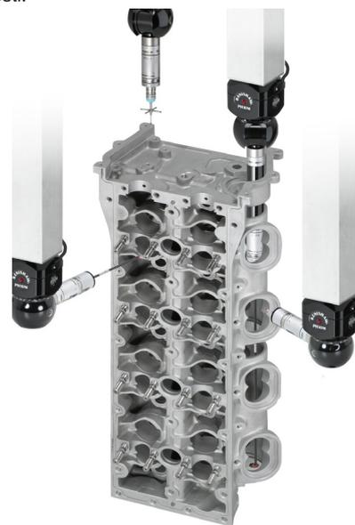
*Le teste indexabili e i sensori modulari consentono di ottenere la massima flessibilità e automazione, fornendo accesso a tutti gli elementi del componente con un'unica impostazione.*
