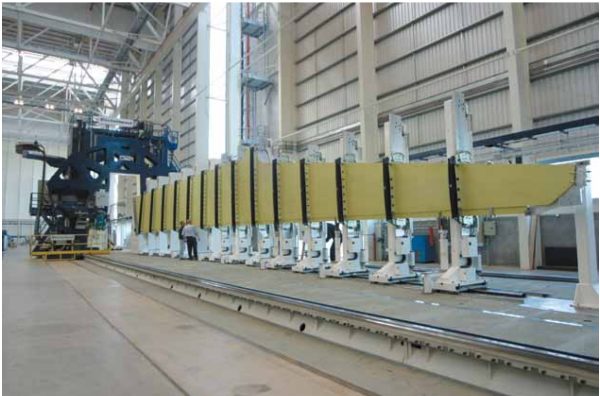
雷尼绍RG4光栅系统集成在这台空客A380的O形翼片装配机上
