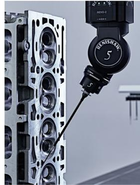
El cabezal de medición REVO-2 incorpora una tecnología de cojinetes esféricos de aire en sus 2 ejes, controlados por motores sin escobillas y unidos a su vez a encóderes de alta resolución que hacen posible un posicionamiento rápido a muy alta precisión.
