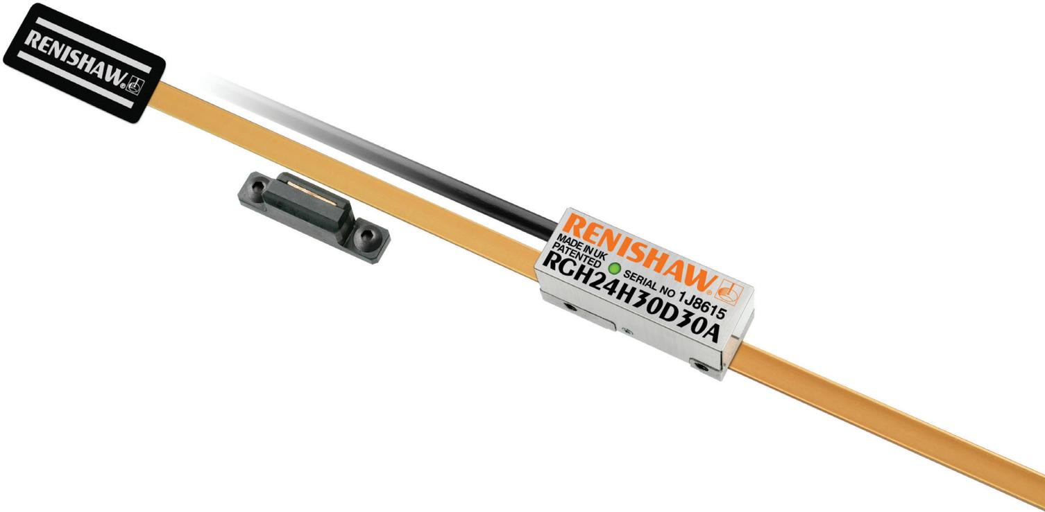
**Renishaw RGH24** 시리즈는 비접촉식 옵티컬 엔코더 시스템입니다. 초소형 판독 헤드는 간편한 설치를 지원하는 셋업 LED 표시기, 이물오염에 우수한 고유의 필터링 옵틱, 최저 **10 nm** 수준의 통합 보간이 강점입니다. 신뢰할 수 있는 성능과 가치가 검증된 **RGH24** 는 가장 널리 채택되고 있는 엔코더 시스템 중 하나입니다.
