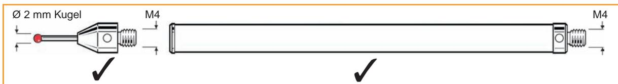
Der Schaft mit dem kleineren Durchmesser ist so kurz als möglich und die M4 Schraubverbindung, welche die Komponenten verbindet, ist um einiges stabiler.
