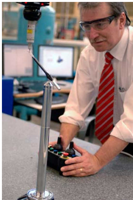
Testování zařízení MCG prováděné na souřadnicovém měřicím stroji v Messier Dowty vybaveném skenovacím systémem Renishaw SP25M
