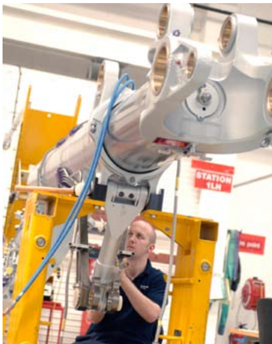
Montáž leteckého podvozku pro společnost Airbus
