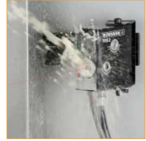
TRS2 – kırık takım tespit sistemi
