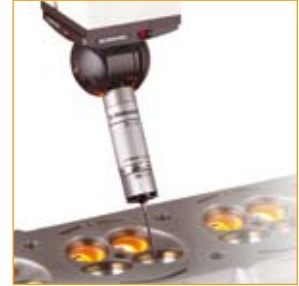
SP25M tarama probu – hızlı ve sürekli veri toplama
