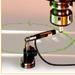
QC10 ballbar – takım tezgahı performansının hızlı bir şekilde test edilmesini sağlar
