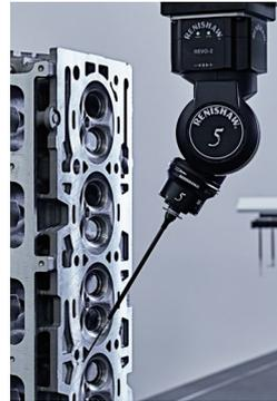
La tête de mesure REVO-2 utilise des patins à air sphériques sur ses 2 axes, entraînés par des moteurs sans balais liés à des codeurs haute résolution pour assurer un positionnement rapide et ultra-précis.
