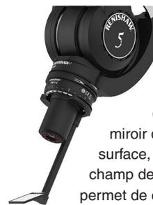
Le miroir orientable (ACM) est un accessoire conçu pour améliorer l'accès au système de vision sans contact RVP. Grâce à un miroir de précision à première surface, l'ACM fait pivoter le champ de vision de 90°, ce qui permet de contrôler les surfaces d'alésage et d'autres entités auparavant inaccessibles au RVP.
