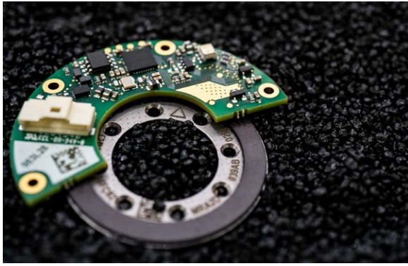
RLS AksIM™绝对式离轴（空心轴）磁编码器
