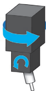
ISO 10791-6 の参照コード = AK ヘッド-ヘッド機 主軸ヘッドに 2 つの回転軸
