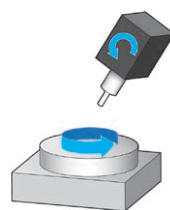
ISO 10791-6 の参照コード = CK CK:ヘッド-テーブル機 スイベルヘッド および/または ロータリーテーブル
