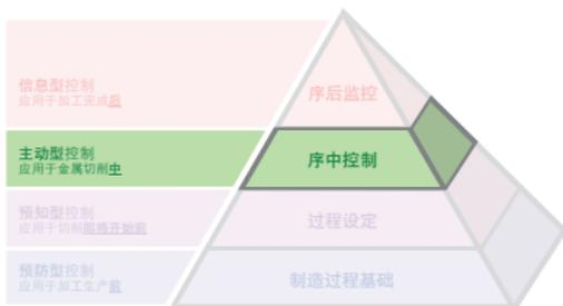
在金字塔中，该层的控制包括嵌入到金属切削过程中的动作，通过自动响应余量状况、固有过程偏差和意外事件，提供成功完成过程控制的最佳时机。
