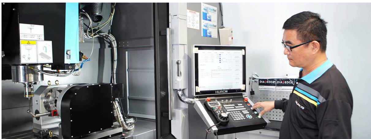
Hurco utilizza anche la sonda a contatto Renishaw RMP600 ad alta precisione per l'ispezione dei pezzi e l'impostazione del lavoro
