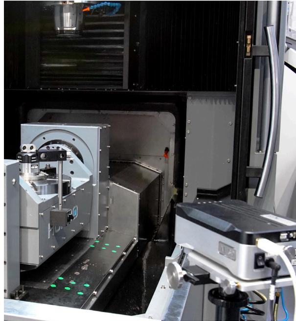
Hurco utilizza anche il sistema interferometrico laser XL-80 e il calibratore per assi rotanti XR20-W di Renishaw
