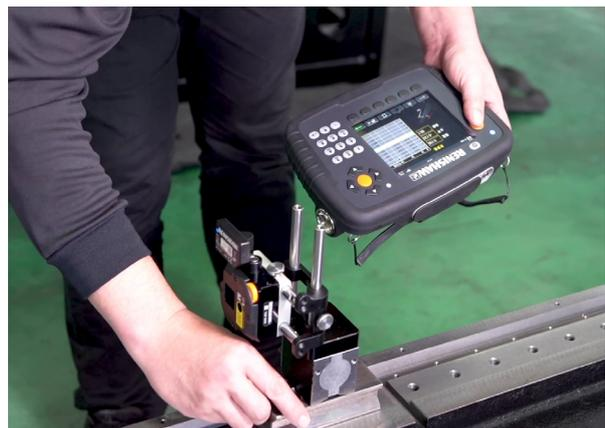
Il display permette all'operatore di raccogliere, analizzare e registrare i dati di misura
