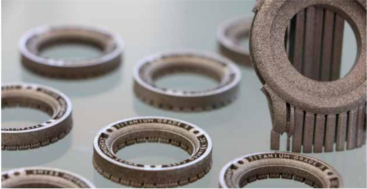
“Ornament 1” 腕表表盘在雷尼绍AM 400系统中采用钛合金材料打印而成。
