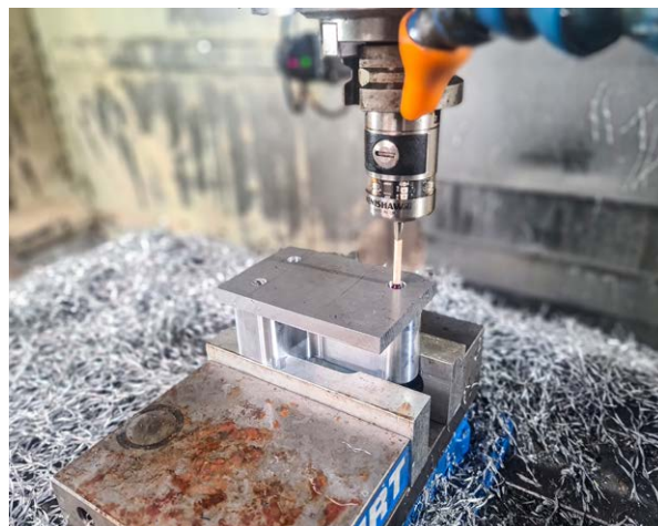
Inställning av arbetsstycken och inspektion med Renishaw's OMP40-2 prob med optisk signalöverföring.
