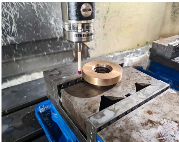
Inställning av arbetsstycken och inspektion med Renishaw's OMP40-2 prob med optisk signalöverföring.
