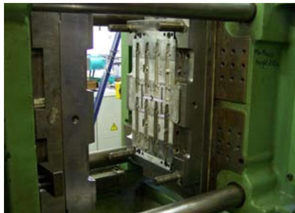
BK Tooling gotovo večdelno orodje preizkusi na lastnem brizgalnem stroju
