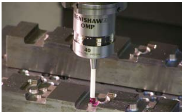
Nastavljanje orodij na stroju je hitro in upošteva termične učinke
