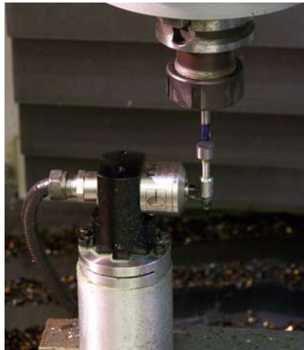
Merilna glava, montirana na vretenu, je pomembna za ponastavitev obdelovanca po repozicioniranju delov
