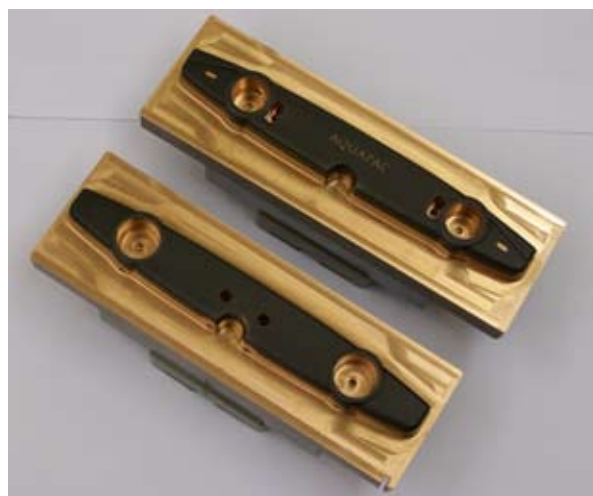
Isti obdelovalni stroj obdeluje tudi orodja za elektroerozijo, s katerimi se na elektroerozijskem stroju končno obdelajo orodja za Aquapac
