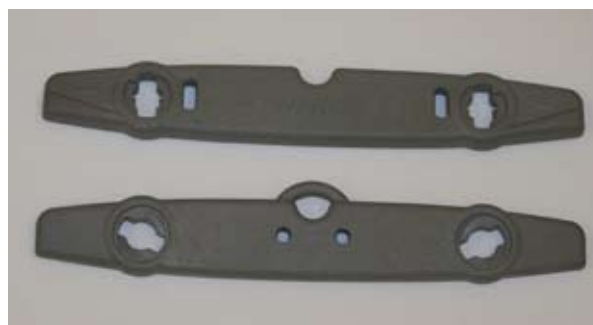
Spojnega dela Aquapac, ki pride iz brizgalnega stroja, ni več treba obdelovati
