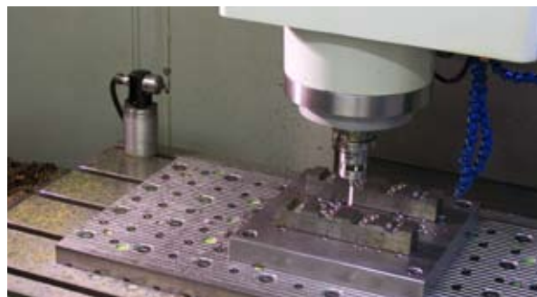
Merilna glava na vretenu nastavi orodje Aquapac za grobo in srednje fino obdelavo
