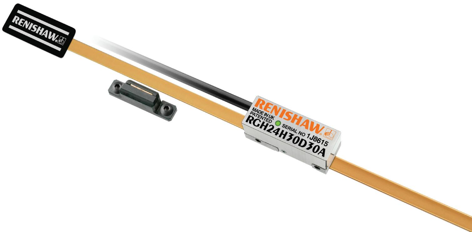
レニショーの RGH24 シリーズは非接触光学式エンコーダシステムです。リードヘッドはコンパクトで、そのリードヘッドには、セットアップ LED と、汚れに対して高い耐性を備えたレニショー独自のオプティカルフィルター機構が搭載されており、内蔵インターポレータにより最大 10nm の分解能を実現しています。RGH24 は、その実証済みの高信頼性パフォーマンス、優れた価値から、最も広く使用されるエンコーダシステムの 1 つになっています。
