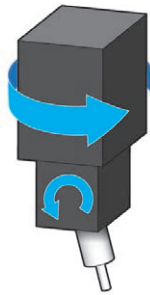
ISO 10791-6 測試項 = 'AK' 擺頭 - 擺頭工具機 2 個旋轉軸位於主軸頭上
