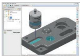
**Superficies construidas:** para crear mediciones adicionales y puntos de datos con características medidas anteriormente. Esta función es especialmente útil para inspeccionar componentes con una gran cantidad de formas de pieza prismática.
