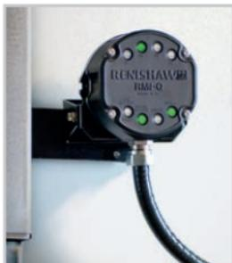
**El sistema de sonda múltiple RMI-Q** es una combinación de transmisor, receptor e interfaz que permite activar el encendido por radio y controlar hasta cuatro sondas individuales Renishaw. Esto permite utilizar varias combinaciones de sondas de inspección o sistemas de reglaje de herramientas por radio en una misma Máquina-Herramienta. A diferencia del sistema de transmisión óptico, no es necesaria una línea de visión directa entre la sonda y el receptor.
