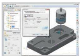
**Tolerancias dimensionales y geométricas (GD&T):** creación de elementos para determinar la relación entre características y realizar una comparación completa de las mediciones de la máquina con los planos de fabricación antes de retirar el componente.
