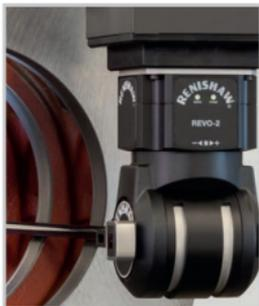
從原本的接觸觸發式測頭、電動轉位測頭座、測針可重複更換與模組化掃描系統，三次元量床（CMM）測頭系統的 Renishaw 感測器已是業界標準。Renishaw 的 5 軸三次元量床技術提供前所未見的速度與量測彈性，同時避免傳統技術中速度與精度天生難以兼顧的窘況。
