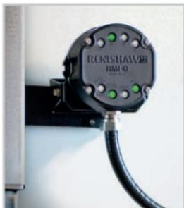
**RMI-Q 多重測頭量測系統** 為一結合發射器、接收器及介面的單元，可啟動個別無線電，並操作高達四個不同的 Renishaw 無線電測頭。因此能在同一個加工機工具內，同時使用多個無線電測頭及／或無線電工具設定裝置。與光學傳輸系統不同，無須在測頭和傳輸器之間達到視線對傳。
