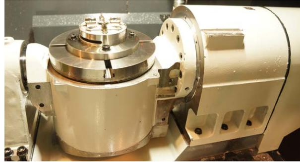
La mesa giratoria del ITRI está equipada con un eje de rotación completa a 360° y uno de inclinación a 170°, ambos con motor propio de transmisión directa (DDR)
