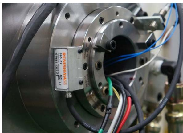
Encóder absoluto RESOLUTE y anillo RESA instalados en el eje de inclinación de la mesa giratoria del ITRI
