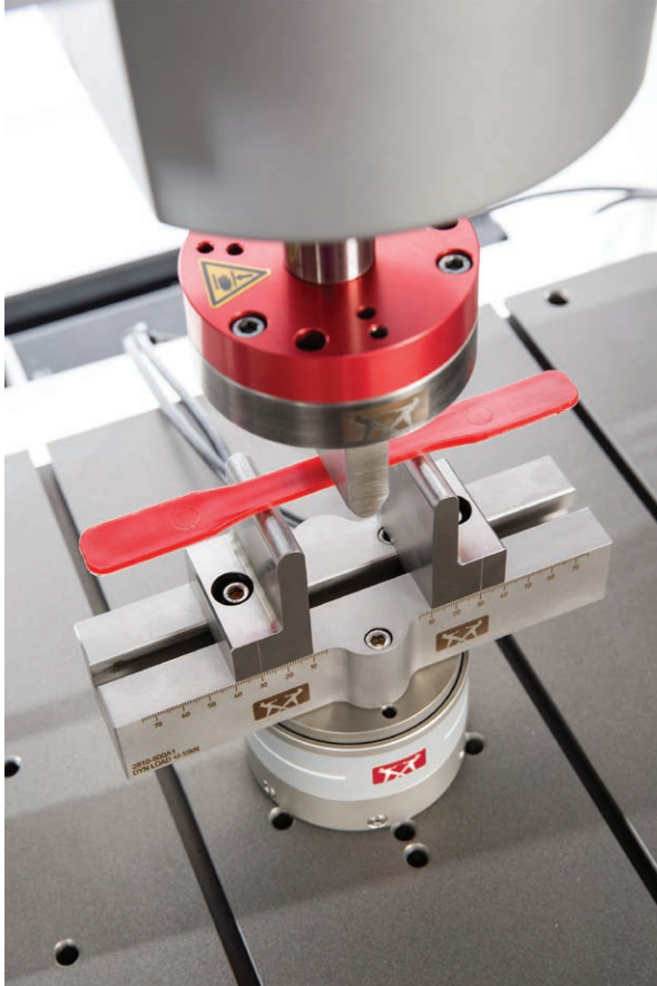
실험적 셋업을 보여주는 테스트 중 폴리프로필렌 샘플
