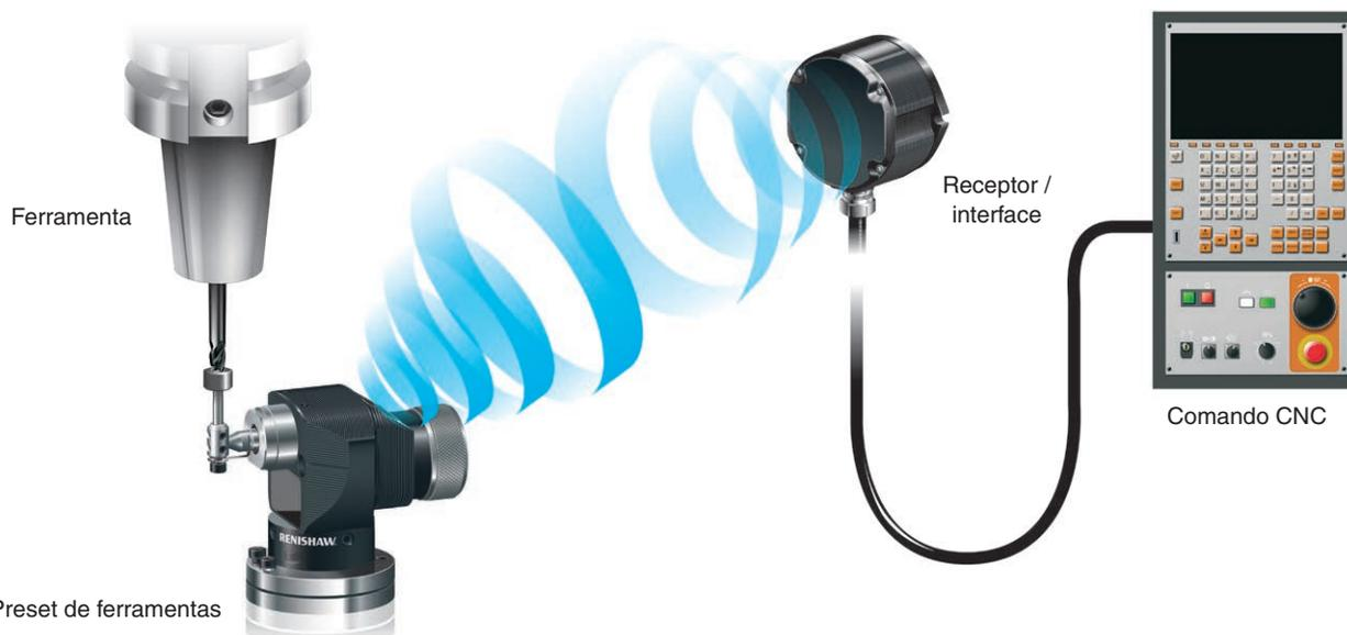
O sistema de transmissão por rádio da Renishaw possibilita a comunicação entre o preset de ferramentas e o comando da máquina e consiste dos seguintes elementos:
