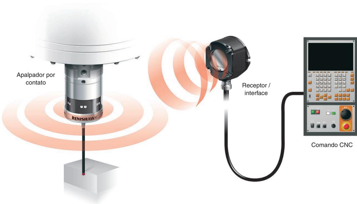
O sistema de transmissão óptica da Renishaw utiliza tecnologia de infravermelho para a comunicação entre o apalpador e o comando CNC e consiste dos seguintes elementos:
