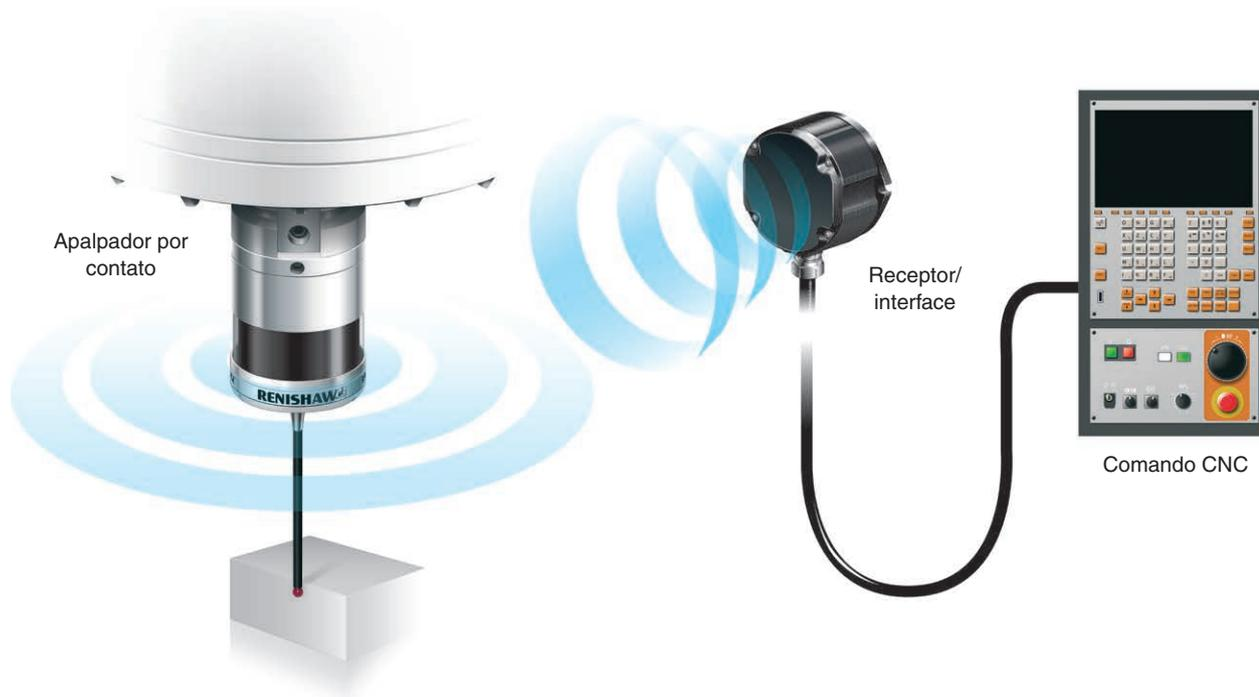
O sistema de transmissão por rádio da Renishaw possibilita a comunicação entre o apalpador e o comando CNC da máquina e consiste dos seguintes elementos:
